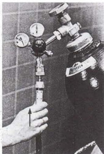
5. La porción terminal del conector del instrumento es introducida en el orificio de salida regulador. Asegúrese de que la válvula del tanque se encuentre completamente abierta.
