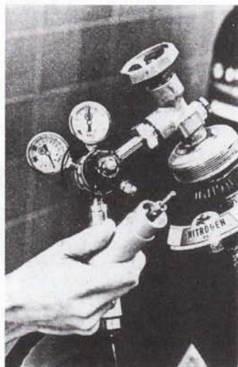
7. Una vez que haya finalizado, cierre el tanque. Mueva el instrumento para extraer todo el aire del manómetro y la tubería. El manómetro del regulador deberá registrar cero. Cierre el regulador girando la perilla verde en sentido contrario a las agujas del reloj hasta el máximo.
