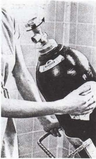
1. Limpie el tubo y su soporte; abra la válvula del tanque (en sentido contrario a las agujas del reloj; observe las flechas) muy lentamente, permitiendo solamente el suficiente escape de gas como para arrastrar cualquier material extraño
