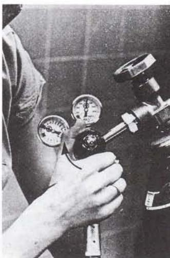
6. Gire la perilla verde a la posición "ON" (en sentido de las agujas del reloj; observe las flechas) y ajuste el nivel de presión en el manómetro izquierdo del regulador de acuerdo con las necesidades del instrumento y del cirujano. NOTA: los ajustes de presión deberán ser efectuados durante el funcionamiento del instrumento, pues si no se obtendrá una presión demasiado baja para operar.
