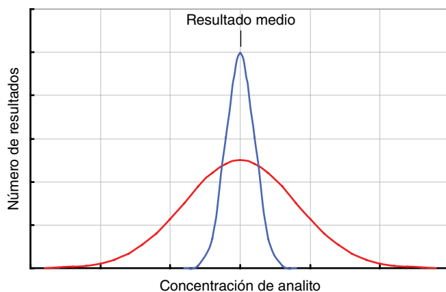
FIGURA 48-1 Precisión de un método analítico. El gráfico muestra los resultados de un analito medido múltiples veces en la misma muestra, sea mediante dos métodos analíticos diferentes, o por medio del mismo método en dos laboratorios diferentes. En ambos casos, el resultado medio es el mismo. Empero, un método o laboratorio, que se muestra en azul, tiene una dispersión de resultados baja y, por ende, una desviación estándar baja, y precisión alta, mientras que el otro, que se muestra en rojo, tiene una dispersión alta de resultados, una desviación estándar alta, y precisión baja.
