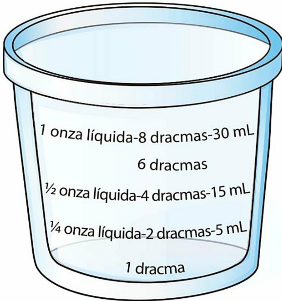
Figura 5–3. Taza medidora de una onza usada comúnmente en hospitales e instituciones similares. Indica equivalentes en los sistemas casero, boticario y métrico.
