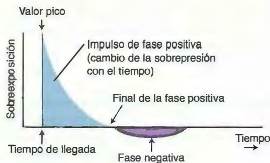
Figura 5-71 Historia de presión-tiempo de una onda explosiva. Esta gráfica muestra el incremento súbito masivo de la presión (sobrepresión de la explosión) después de la reducción de la presión y la fase de presión negativa.
