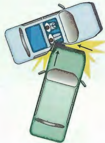
Figura 5-23 La invasión de los paneles laterales en el compartimento del pasajero es otra fuente de lesión.
