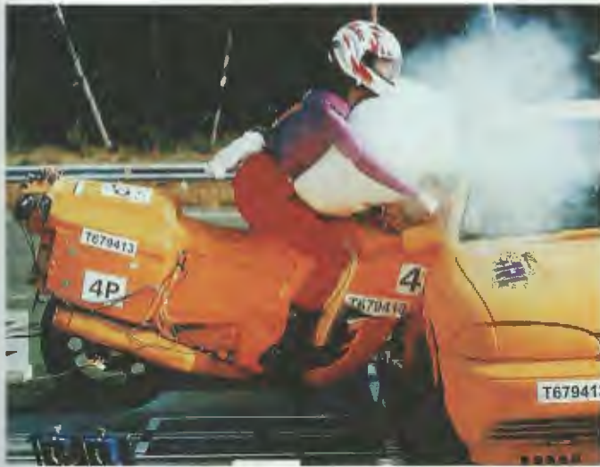
Figura 5-33 Cuando una motocicleta se impacta de frente con un objeto, la posición de un motociclista es por encima del punto pivote de la lanta delantera.
