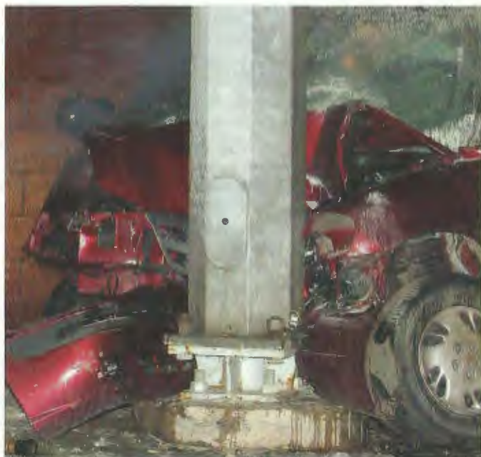
Figura 5-11 Cuando un vehículo se impacta contra un poste de luz, el frente del automóvil se detiene pero la parte trasera del vehículo continúa su movimiento hacia delante, lo que produce la deformación del vehículo. Fuente: © Jack Dagley Photography/Shutterstock, Inc.
